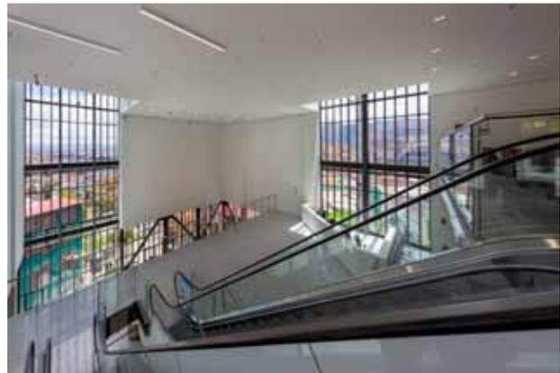
pic\_05: Das Raster des aussen liegenden Sonnenschutzes bestimmt die Grösse der Glaselemente, die i.d.R. 1,20 m x 2,40 m messen.
