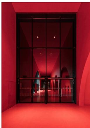
**Bild 1:** Knallrot ist das neue, repräsentative Foyer der Messe Dornbirn. Raumhoch verglaste Öffnungen leiten von hier aus durch die Abfolge der Hallen. Für die stark frequentierten Erschließungsbereiche wählte man die Brandschutztüren Janisol C4 EI60.
