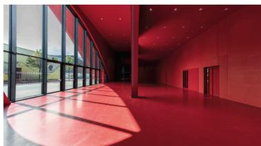
**Bild 3:** Zwischen den Fassadenstützen mit Querriegeln öffnen im Brandfall rund 70 Türen den Weg ins Freie. Für diese stark frequentierten Erschließungsbereiche kamen Brandschutztüren Janisol C4 EI60 zum Einsatz.
