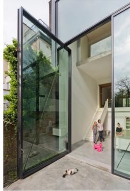
**Bild 6 und 7:** Im geöffneten „neuen“ Teil zeigt sich der Bau sachlich und minimalistisch: Die Wände, neue Decken und Brüstungen bestehen aus Beton und sind weiß verputzt und gestrichen.
