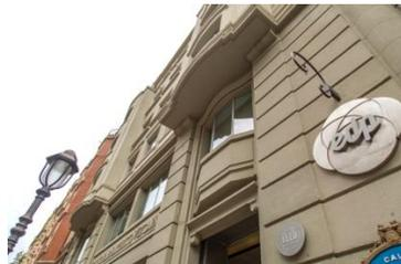
Bilder 2+3: Um den ursprünglichen Charakter der Fassade zu erhalten, wurden die alten Stahlprofile durch die Profile Janisol Arte ersetzt, welche technisch die hochgestellten Anforderungen erfüllen.
