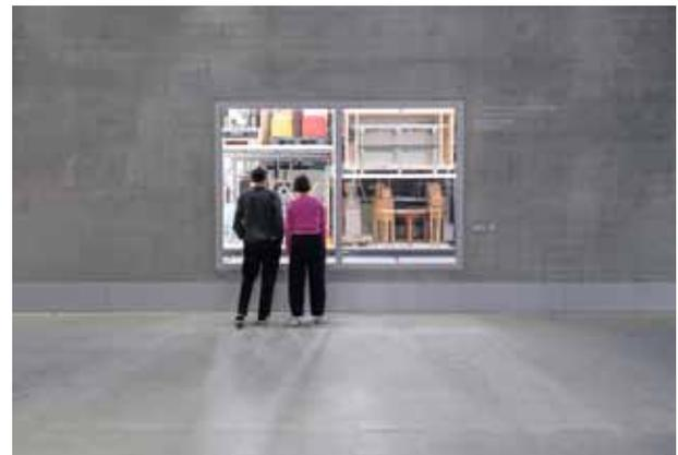
pic\_06: 302\_Depot\_november: Einblicke: Brandschutzfenster zu einem Lagerraum. Die Verglasung erfolgte mit eisenarmem Spezialglas, das die Farbigkeit der Exponate nicht verfälscht.
