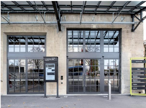
DSC5058.jpg: Haupteingang zur Hans-Preissinger-Strasse hin; gefertigt aus den Stahlssystemen VISS Fassade und Janisol.
