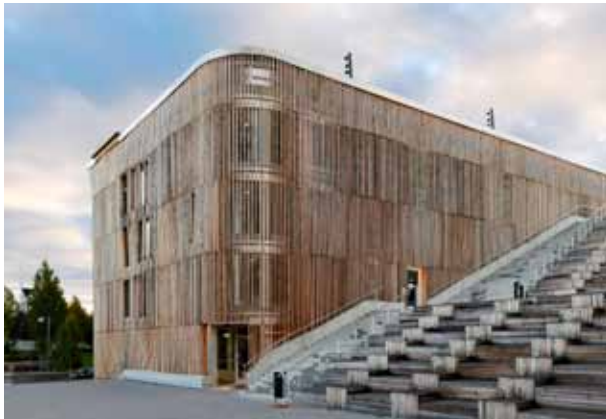
pic_4_FMO160915_1363.jpg : Eine Vorhangfassade aus feinen, senkrecht angebrachten Lamellen aus heimischer Lärche umhüllt die Primärkonstruktion. Sanfte Wölbungen in der Lamellenstruktur verstärken den natürlichen Eindruck.
