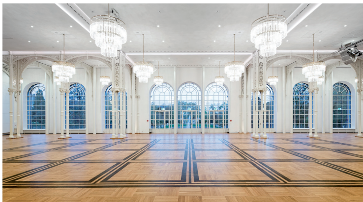
pic_04_jw1599-0066.jpg: Für die Rekonstruktion der umlaufenden historischen Befensterung wählten die Planer das wärmedämmende Stahlprofil Janisol von Jansen, CH-Oberriet.
