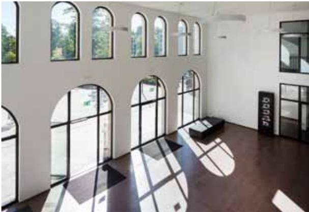
pic\_04\_phelps\_1852.jpg: Für den neuen Haupteingang wurde die zuvor geschlossene Fassade mit vier grossformatigen Portalen zu einem einladenden Entrée geöffnet und die Geschosdecke zwischen UG und EG entfernt, sodass ein liches Foyer entstand.
