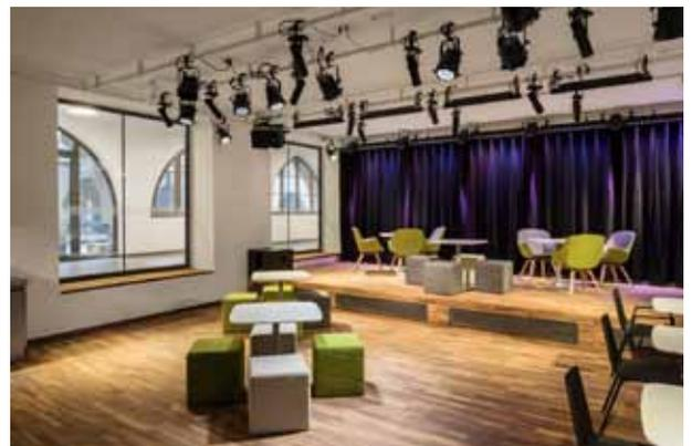
pic\_07\_phelps\_0003.jpg: Blick in die Cafeteria, die auch als „Jazzkeller“ genutzt wird. Sie ist über eine Festverglasung aus Janisol 2 (Brandschutzanforderung EI30) belichtet, die Blickbeziehungen in den Innenhof ermöglicht.
