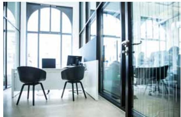
pic\_08\_089\_IHK\_Stammhaus\_innen.jpg: Beratungsraum im EG. Trennwand aus dem VISS-Fassadenprofilssystem mit Einselelement aus der Profilerie Economy 60; Fenster aus Janisol.
