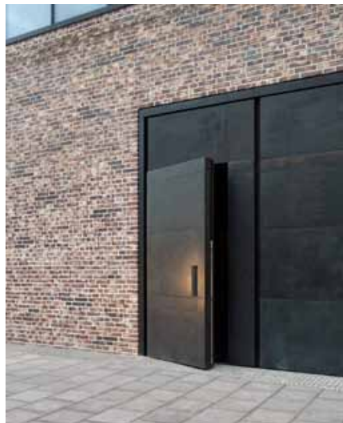
pic_05: Damit die Einbringungsöffnung flächenbündig im Mauerwerk zu liegen kommt, wurden die vollverblechten Tür- und Tor Konstruktionen aufgedoppelt. Die Bänder sind im Falz verdeckt liegend integriert (Janisol HI).
