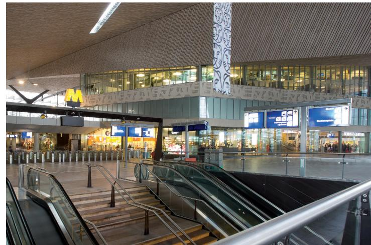
pic\_09.tif: ... während die darüber liegenden Büroräume der Brandschutzanforderung EI60 genügen mussten. Sie wurden mit dem Profilsystem Jansen VISS Fire realisiert.
