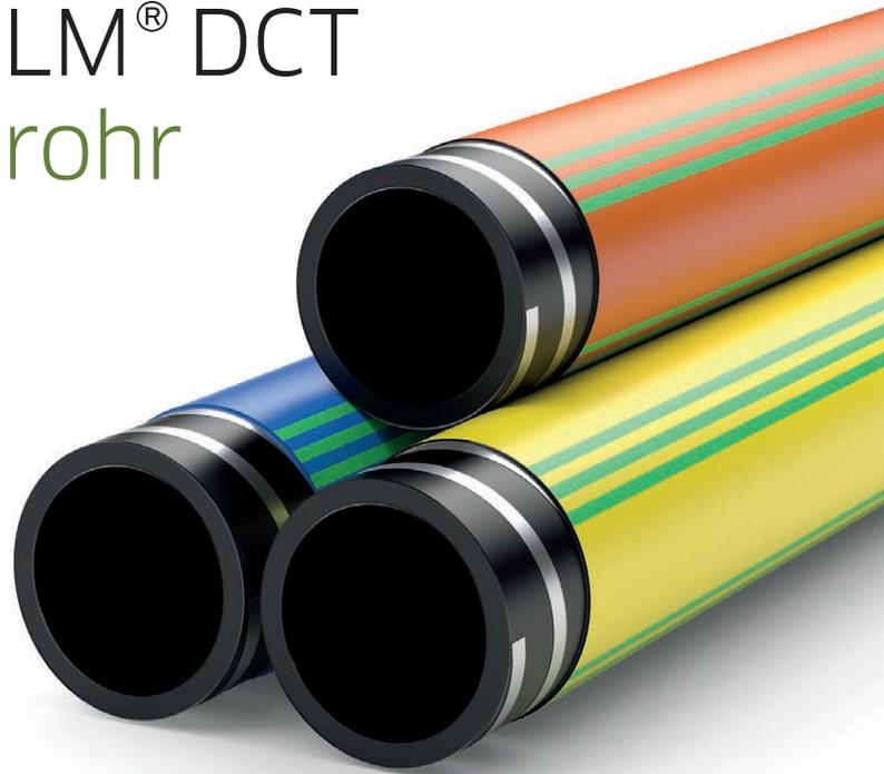
Das Jansen Egeplast SLM<sup>®</sup> DCT ist ein Rohrsystem aus PE 100 RC mit additiver Schutzschicht und integrierten Leiterbändern. Diese ermöglichen eine Prüfung des Rohrsystems auf Unversehrtheit direkt nach der Verlegung. Sie bieten darüber hinaus die Möglichkeit einer dauerhaften Ortung der verlegten Leitung.
