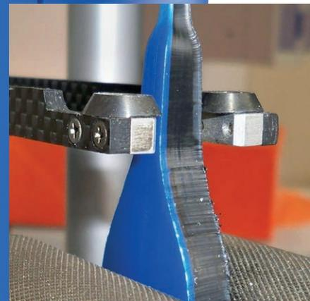
Wavin TS<sup>DOQ</sup>® ist ein koextrudiertes Dreischichtrohr mit einer farbigen inneren und äusseren Schutzschicht und einer schwarzen Mittelschicht aus PE 100 RC. Es lässt sich wie ein Standard-PE-Rohr verarbeiten.
