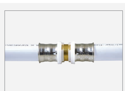
Zwischen 1 und 4.5 bar geprüfter verpresster Fitting – dicht
