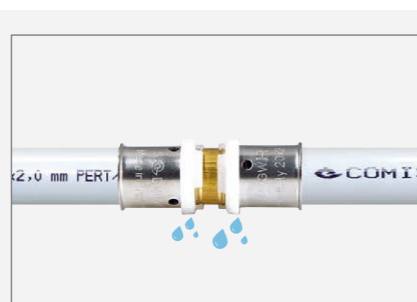
Zwischen 1 und 4.5 bar geprüfter nicht verpresster Fitting – undicht
