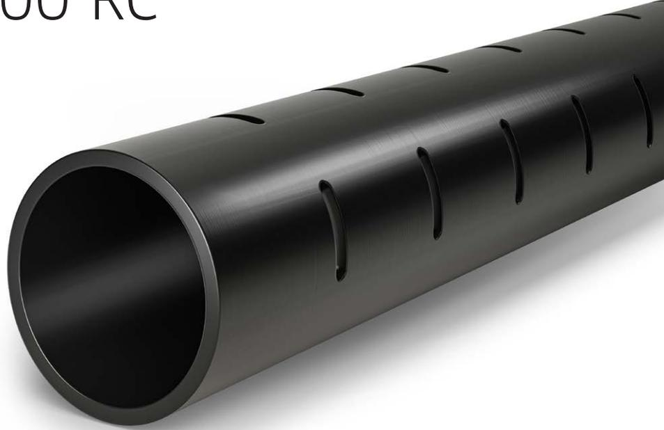
Drainagerohre JANSEN PE 100 RC aus modifiziertem PE weisen einen höheren Widerstand gegenüber langsamer Rissfortpflanzung und Spannungsrissen auf. Dies wird in der PAS 1075 im Zusammenhang mit alternativen Verlegearten beschrieben. Das unbearbeitete Grundrohr hat folgende Zertifizierungen: SVGW-Zertifizierung K 111, SN EN 12201.
