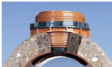
Der **Fabekun Anschlussattel** eignet sich für den seitlichen Anschluss an **dickwandige** Hauptkanalisationsleitungen, beispielsweise aus Beton, Steinzeug oder Faserzement im Winkel von 90° dicht eingebunden. Durch das integrierte Kugelgelenk erhöhen sich Flexibilität und Gelenkigkeit deutlich.
