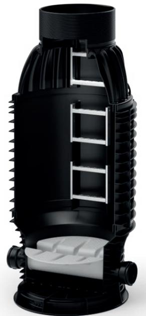
Das modulare System gewährleistet bei engen Terminvorgaben einen schnellen Baufortschritt. Für den Transport und die Installation sind keine grossen Hilfsmittel erforderlich. Mit einer Doppellippendichtung wird zwischen den einzelnen Schachtkomponenten eine absolute Dichtheit gegen Wasserdruck von innen und aussen erreicht.
