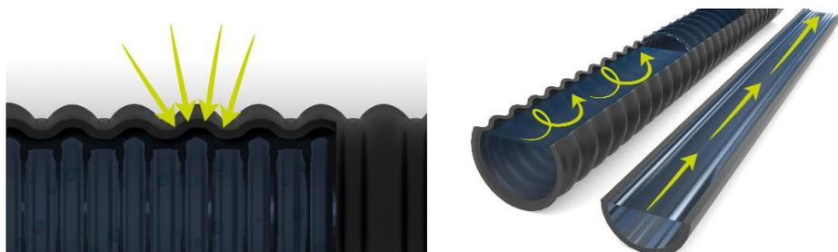
Abb. 5: Das 63-mm-Wellrohr der JANSEN powerwave single-u bietet eine große Oberfläche für die Energieaufnahme. Und die innere Wellung bildet Turbulenzen in der Strömung – schon bei sehr geringem Volumendurchsatz, wo herkömmliche Glattrohre laminare Verhältnisse zeigen.
