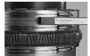
Nach dem Ausrichten der Rohrkupplung wird der VPC-Tangentialspanner mit dem Haltefuß unter die Spannschlösser geschoben. Dann wird der Löffel des Zugarmes in die Halteöse eingehakt und mit einem Drehmomentschlüssel festgezogen.
