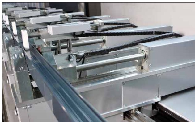
Spannbock mit Absolut-Wegmesssystem und Vertikalspanner Clamp with absolute position measuring system and vertical clamps
