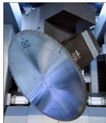
Bearbeitungskopf einseitig aufgehängt Processing head mounted on one side
