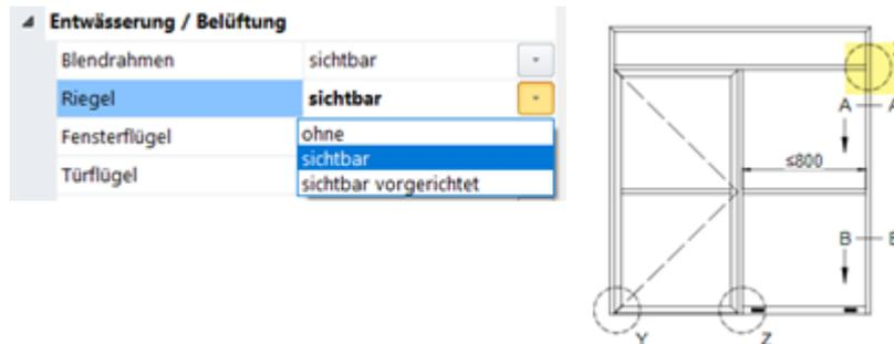
Se si seleziona l'impostazione *visibile*, le operazioni di lavorazione vengono generate in base ai disegni di produzione K1014208 e K18012:
