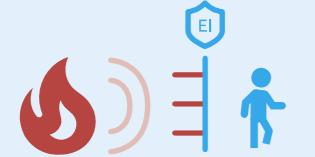
*Critère de performance EI «Étanchéité et isolation thermique»: Empêche le passage du feu et de la chaleur. La hausse de température sur le côté non exposé de l'élément ne doit pas dépasser 180°C ou une moyenne de 140°C.*
