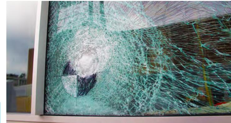
Der Prüfstand der Hochschule zählt zu den modernsten in Europa und erlaubt es, Fassaden bis zu einer Breite von acht Metern und einer Höhe von zwölf Metern zu testen. Er besteht aus einer an beliebige Fassadengrößen anpassbaren abgedichteten Prüfkammer, mit der Prüfdrücke bis zu zehn Kilopascal aufgebracht werden können sowie einer mit Wasserdüsen bestückten Beregnungseinheit.
