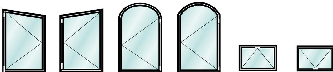
Fenêtre trapézoïdale      Fenêtre en demi-rond      Fenêtre à arc surbaissé      Fenêtre à soufflet (cintré)      Fenêtre à basculante
