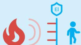
**Leistungskriterium EI «Raumabschluss und Wärmedämmung»:** Der Durchgang von Feuer und Wärme wird verhindert. Der Temperaturanstieg auf der feuerabgewandten Seite des Elementes darf 180°C bzw. durchschnittlich 140°C nicht überschreiten.
