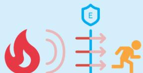
**Leistungskriterium E «Raumabschluss»:** Der Durchgang von Feuer wird verhindert, jedoch nicht der Durchgang der Wärme.
