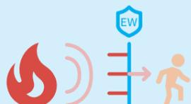
**Leistungskriterium EW «Raumabschluss und Strahlungsminderung»:** Der Durchgang von Feuer wird verhindert. Zudem ist die Wärmeübertragung auf 15 kW/m<sup>2</sup> begrenzt.
